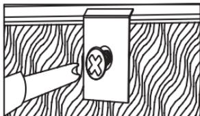
En los orificios que traen las bridas, coloque los cuatro (4) tornillos de 6x  $\frac{5}{8}$  CP. PH.
